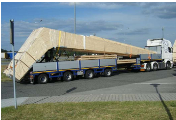
Transport ponadgabarytowy ram trójprzegubowych o złączu klinowym
